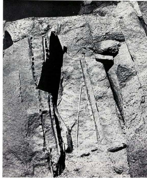
a) Mons Claudianus. Pillar-Wadi. Abschalen einer Granitgruppe parallel natürlicher Abgänge durch Stoß- und Hebspaltungen
